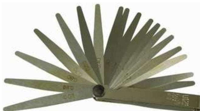
Søgerblade bruges til at måle tandingen i bordplader
