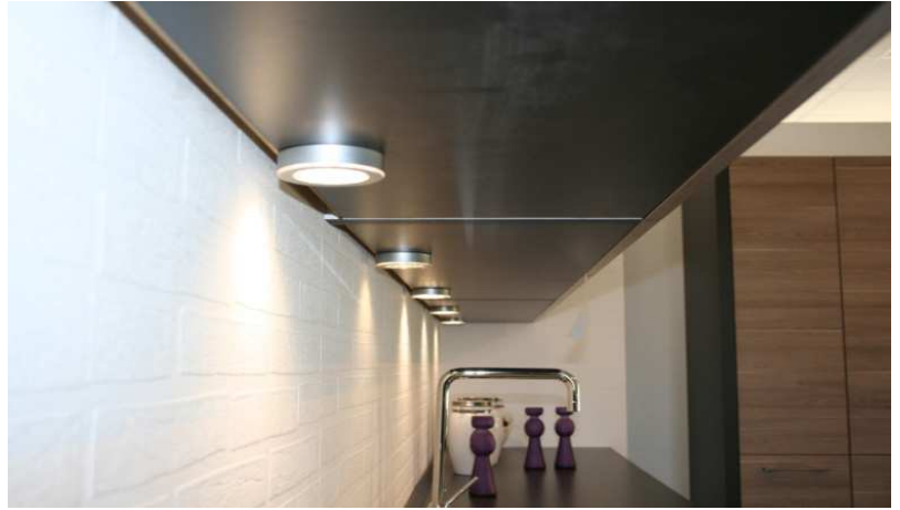
Spot monteres maksimalt 10mm fra bagkant skab.
