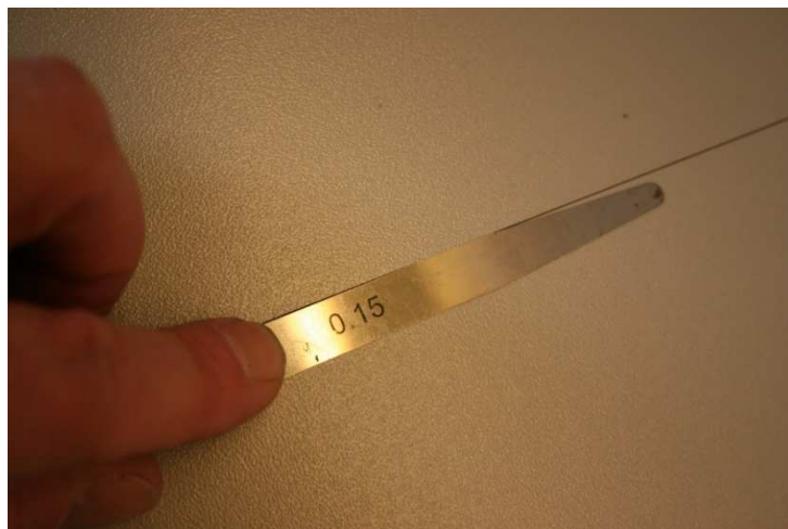
Tanding i bordpladesamling kontrolleres med søgerblade, men kan grovt tjekkes med visitkort.
